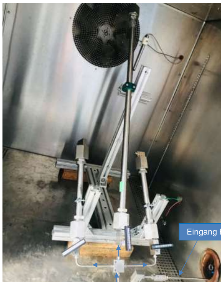
Abb. 1: Druckbehälter in der Klimakammer für Wasserstoffkompatibilitätstest
